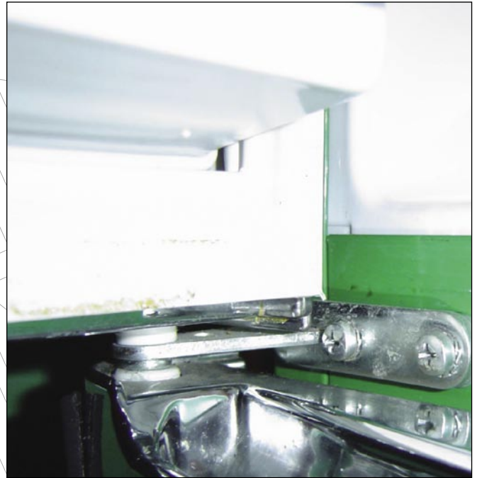
Figura 60 Fijación de la puerta sobre el cuerpo de una nevera.
