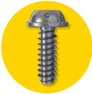
La vis REMFORM® II F™ (pas fin) est spécifiquement recommandée pour un assemblage de pièces moulées sous pression en aluminium et en magnésium, des profils en aluminium extrudé, des plastiques renforcés en fibres de verre à haute résistance et autres matériaux à faible ductilité.
