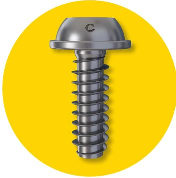
El tornillo autorroscante REMFORM® II F™ (Fine Thread) está especialmente diseñado para el ensamblaje directo de materiales con baja ductilidad, tales como plásticos altamente cargados con fibra de vidrio, plásticos termoestables y resinas fenólicas entre otros, y ensamblajes con longitudes de engarce reducidas.
